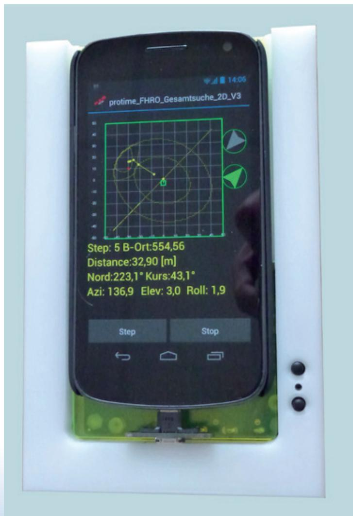
Mit zusätzlicher Hardware und der LawinenFon-App wird jedes Smartphone zum Lawinensuchgerät. Im Bild: der Prototyp des Galileo-LawinenFon.
