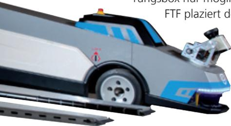
FTF platziert den Pkw nach Anforderung des Fahrzeugs in der Box so, dass der Fahrer sie einfach vorwärts fahrend wieder verlassen kann.
